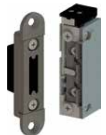
Set ohne Schließblech Für die flexible Verwendung mit ProFix®2 Schließ- blechen der Marke effeff. Türöffner mit Rückmelde- kontakt und Schutzdiode.
